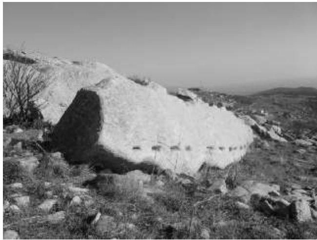
Blocco preparato per il taglio (si notino i fori per i cunei di legno)
