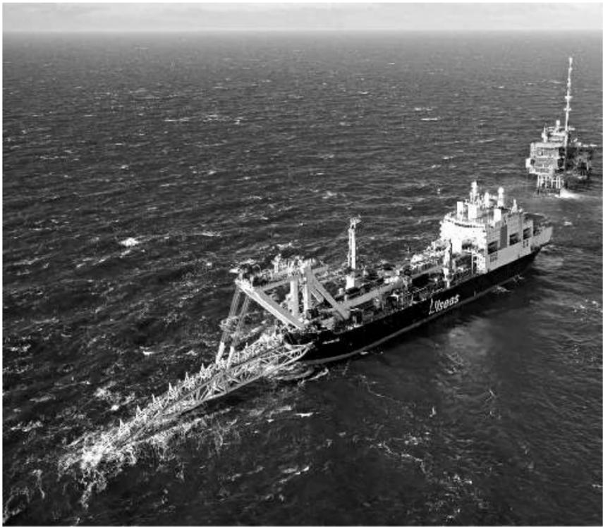
Un'imbarcazione per la posa del gasdotto
